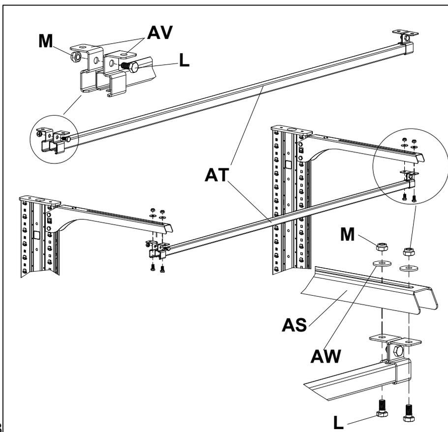
Наживить кронштейны **AV** на перекладину-направляющую **AT** в двух местах при помощи болтов **L** (M8x16) и гаек **M**. Наживить кронштейны вместе с перекладиной-направляющей на консоли **AS** при помощи болтов **L** (M8x16), шайб широких **AW** и гаек **M**.
