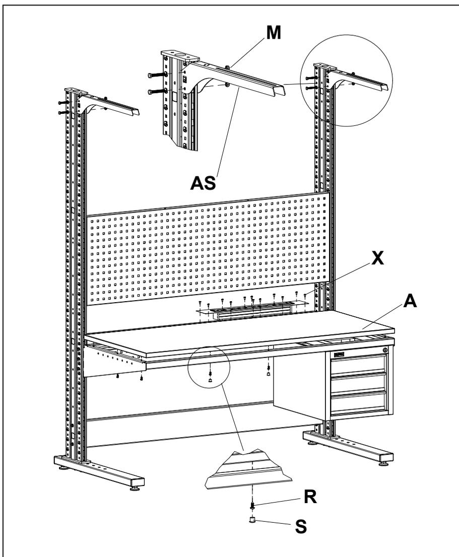
Установить столешницу **A** при помощи саморезов **R** (5,5x16). Установить заглушки **S** в отверстия в раме. Установить наполнение короба для коммуникаций по месту при помощи саморезов **X** (4,8x13). Установить консоли **AS** на стойки при помощи входящих в комплект консоли болтов **K** (M8x50) и гаек **M**.
