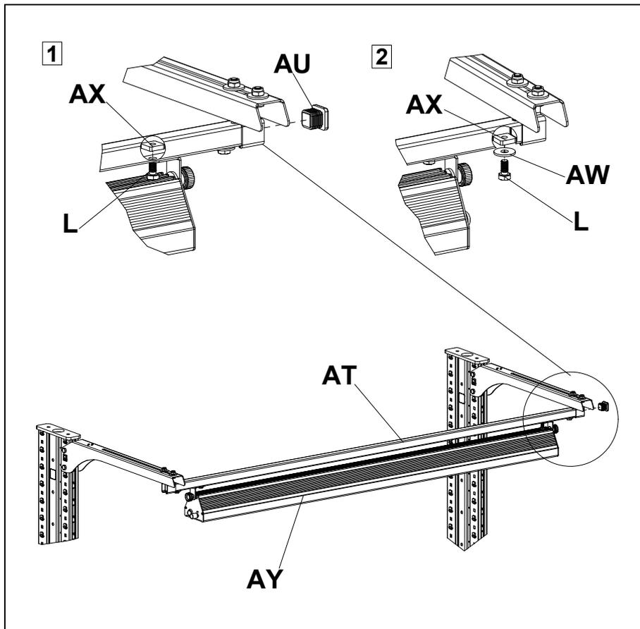
Наживить на светильник болты **L** (M8x16) и пластины **AX**. Завести светильник **AY** в перекладину-направляющую **AT**.
