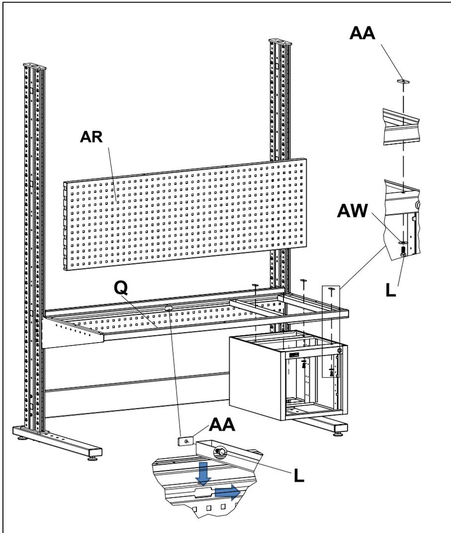
При наличии подвесной тумбы наживить на кронштейны **Z** прямоугольные гайки **AA** болтами **L** (M8x16). Затем завести кронштейны через прямоугольные отверстия в центре рамы **Q** в место установки тумбы.
