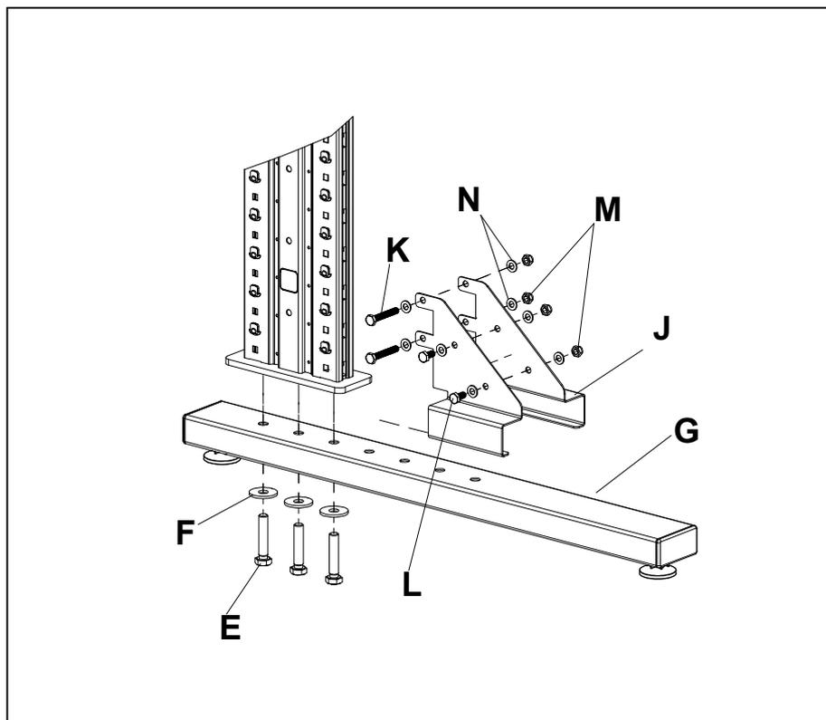
**Внимание!** При сборке одностороннего рабочего места установить стойки **D** на основания **G** с краю при помощи болтов **E** (M12x60) и шайб **F**.
