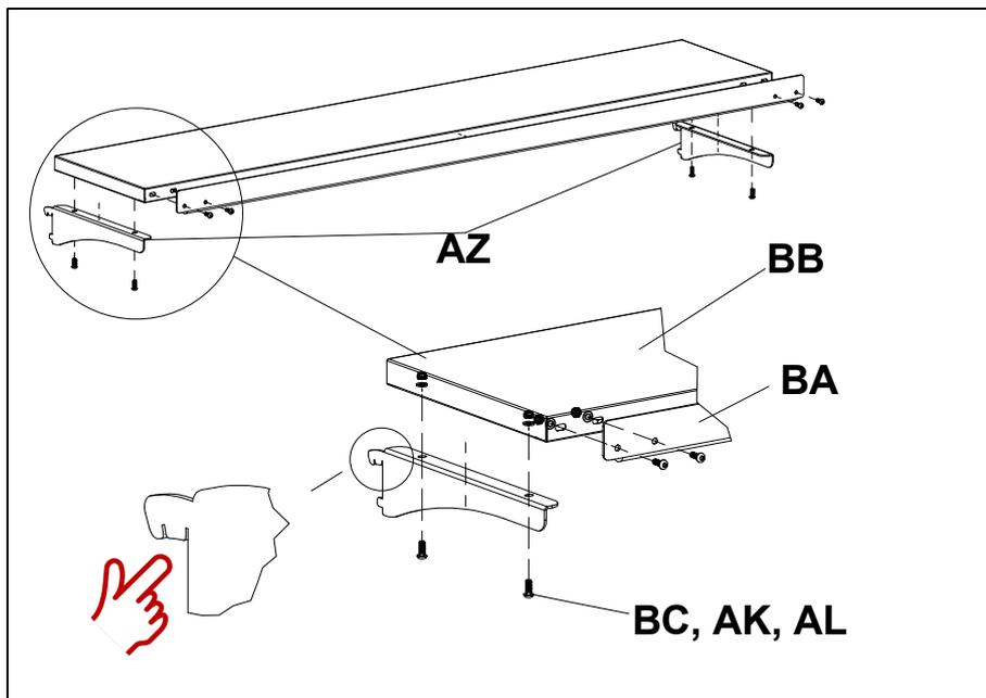
Установить на полку **BB** кронштейны **AZ** (левый и правый) и упор **BA** винтами **BC** (M6x16), шайбами **AK** и гайками самоконтрящимися **AL**. Установить полку в отверстия стоек экрана прямо или под углом на соответствующие зацепы на кронштейнах полки.
