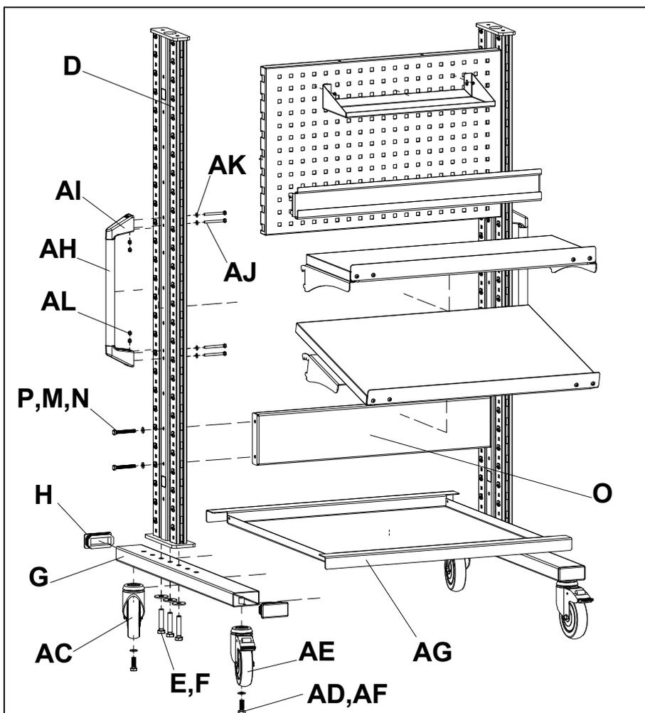
При сборке ВС-К тележки необходимо в пункте **3.1** вместо опор установить колёса **AC**, **AE** при помощи болтов **AD** (M10x30) и шайб **AF**.
