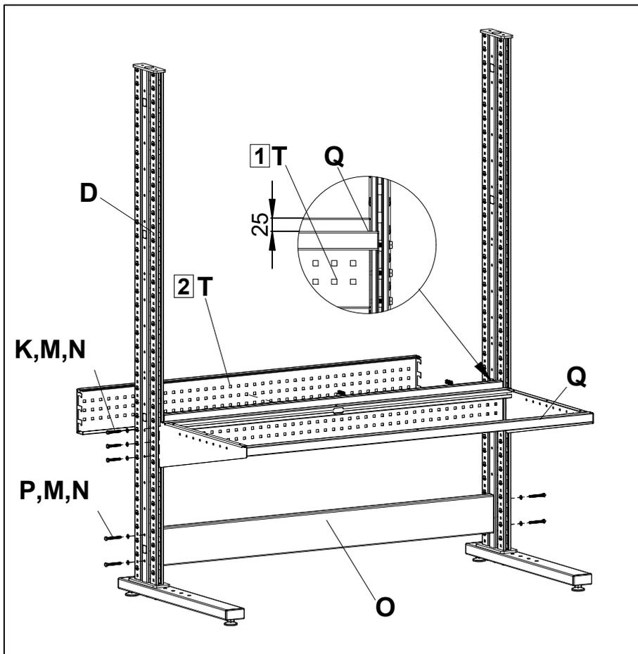
**Внимание! Протянуть крепеж после установки экранов, но до установки столешницы.**
